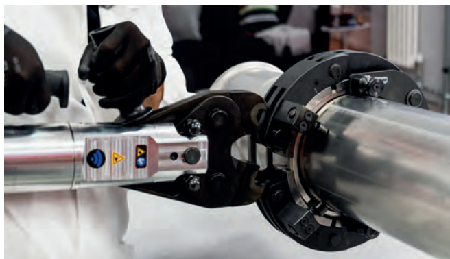
Bilde 39 – Montering av press, 1. fase
